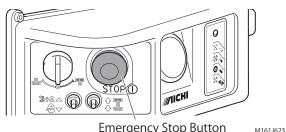
Emergency Stop Button Fig. 8–5 (Untere Steuerelemente)
